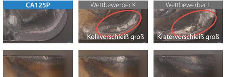
Schnittbedingungen:  $V_c = 300$  m/min,  $a_p = 1,5$  mm,  $f = 0,3$  mm/U, Nassbearbeitung
