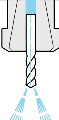
// Präzise Kühlungen der Schneide und verbesserte Späneabfuhr
