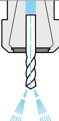
// Präzise Kühlung an der Schneide und verbesserte Späneabfuhr
