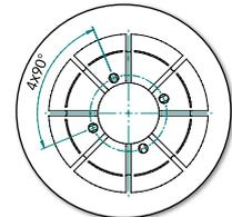
4 Kühlbohrungen mit  $\varnothing$  1.5 mm über alle ER Grössen
