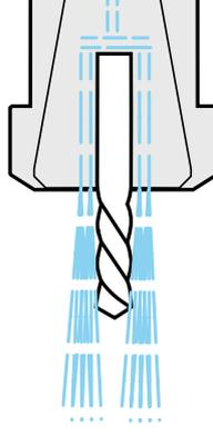
// Keine zusätzlichen Komponenten nötig und kompatibel mit der Standard ER Spannmutter
