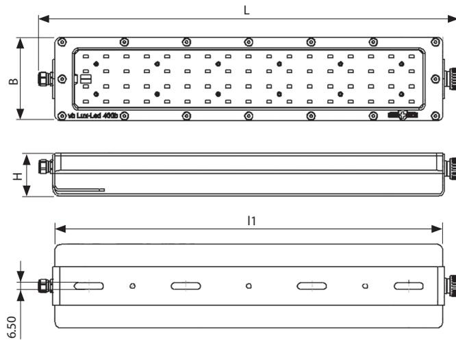
Standardausführung mit 2 m Kabel, Floatglas (klar), Befestigungsbügel, Betrieb direkt 24 VDC.
