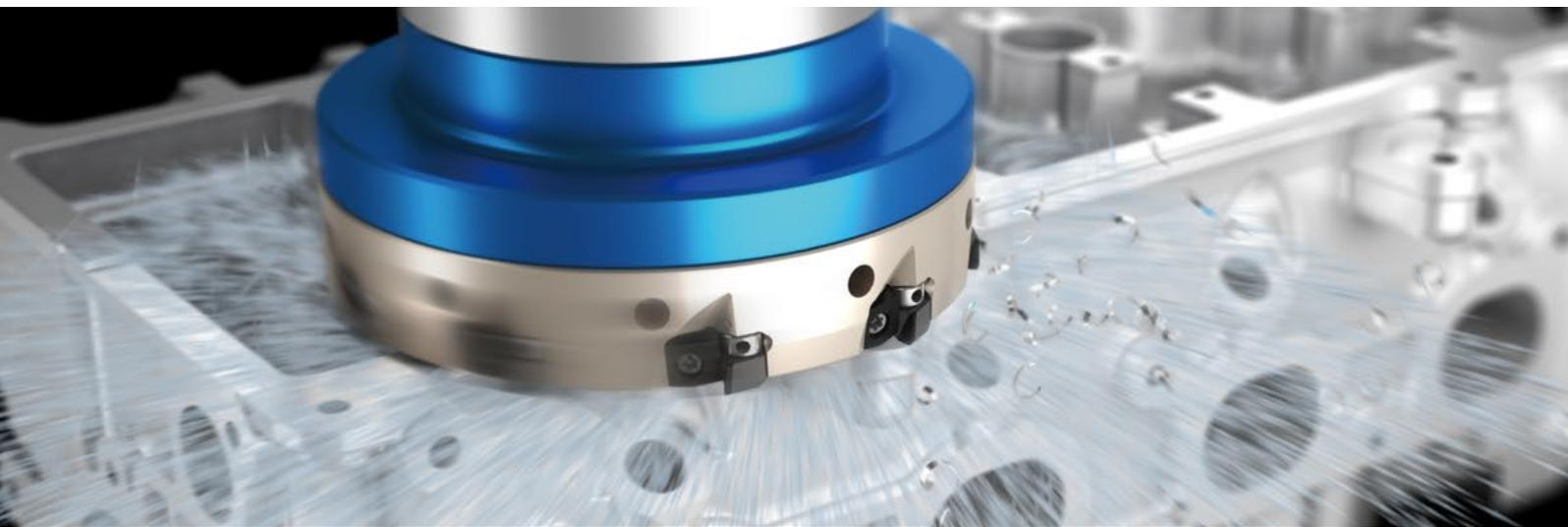
Niedrige Schnittkräfte minimieren Gratbildung sowie Spanschlag und sorgen für eine hochwertige Bearbeitung
