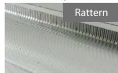
Schnittbedingungen:  $V_c = 220$  m/min,  $a_p = 3$  mm (Nutenfräsen),  $f_z = 0,10$  mm/Z,  $\phi 20$  (3 Wendeschneidplatten), Trockenbearbeitung, Werkstück: 42CrMo4
