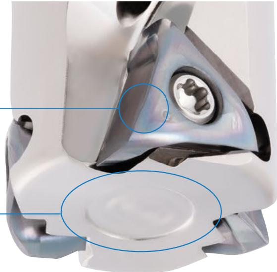
Der konstante maximale axiale Spanwinkel von 17° sorgt für geringe Schnittkräfte als bei den positiven Wendeschneidplattentypen der Wettbewerber
