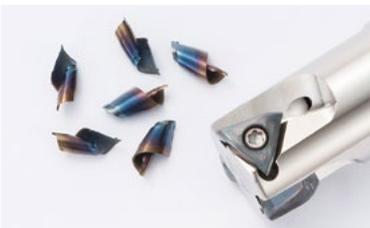
Schnittbedingungen:  $V_c = 150$  m/min,  $a_p = 6$  mm (Nutenfräsen),  $f_z = 0,2$  mm/Z,  $\phi 20$  (3 Wendeschneidplatten), Trockenbearbeitung, Werkstück: ST44-2
