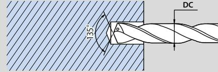
③ Anheben der Drehzahl auf die angegebene Geschwindigkeit und starten des Bohrvorgangs.
