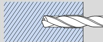
④ Nach dem Bohren das Werkzeug vom Grund abheben, danach die Drehzahl auf 500 bis 1000 min<sup>-1</sup> (n) reduzieren und aus der Bohrung ausfahren.
