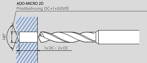
★ Bitte verwenden Sie bei gekrümmten Oberflächen, vor dem Bohren der Pilotbohrung den ADF (VHM Flachbohrer) zum Anbringen einer Fläche.
